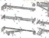
Рис. 4. Виды шаблонов для криволинейных тяг:
