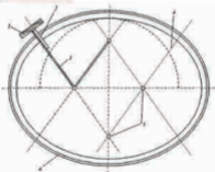
Рис. 9. Выполнение овальной тяги шаблоном на тесьме: 1 — ползкок; 2 — профильная доска; 3 — тесьма; 4 — линии разметки; 5 — гвозди, забитые в центрах кривизны; 6 — готовая тяга
