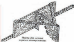
Рис. 1. Шаблон для вытягивания карнизов
